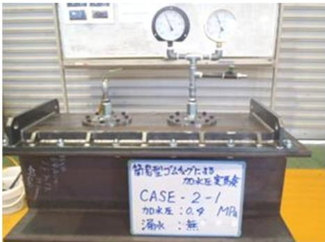
写真-1 簡易型ゴムチューブによる加水圧実験
